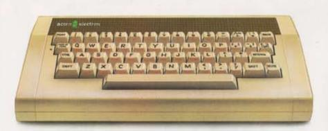
Der Electron besitzt eine Speicherkapazität von 64 K. Davon entfallen 32 K auf den Lesespeicher (ROM) mit dem Betriebssystem und dem BASIC-Interpreter. Der Arbeitsspeicher (RAM) umfaßt 32 K, von denen 3,5 K für das Betriebssystem benötigt werden.
